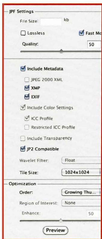
Fig. 2 • Submenu do Photoshop com todos os ajustes do JPEG 2000, lossy, lossless, e controles sobre o método de compressão e tamanho de amostras
